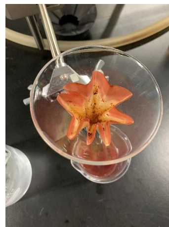
図3:ろ過の様子 ろ紙に茶色の沈殿物が見られる。
