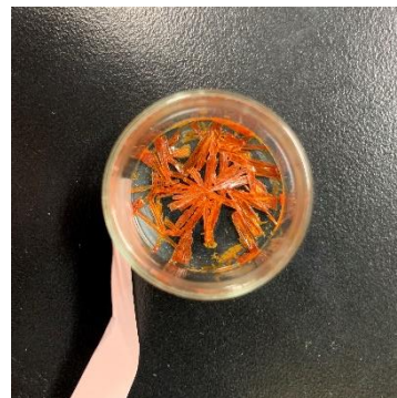
図 12:蒸発して得られた [\text{Co}(\text{en})_3]\text{Cl}_3 の結晶 橙色の結晶が針状に見られた。
